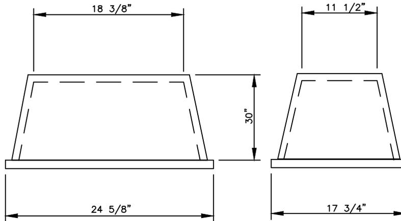
STANDARD HEAVY DUTY POLYMER CONCRETE METER BOX
