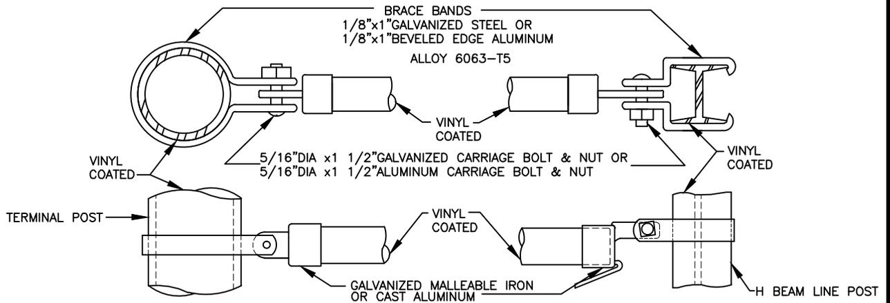
**BRACE RAIL ATTACHMENT FOR ROUND CONSTRUCTION**
