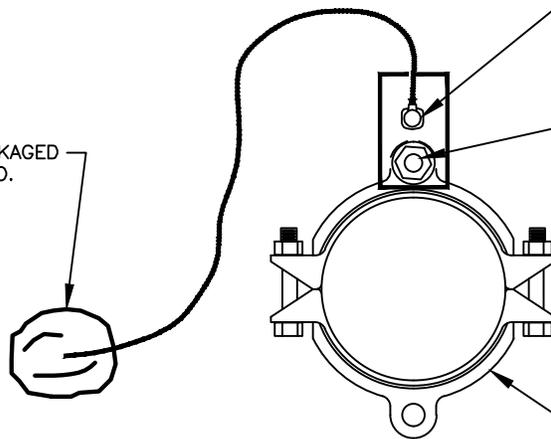
DUCTILE IRON RESTRAINING JOINT HARNESS FOR PVC PIPE.
