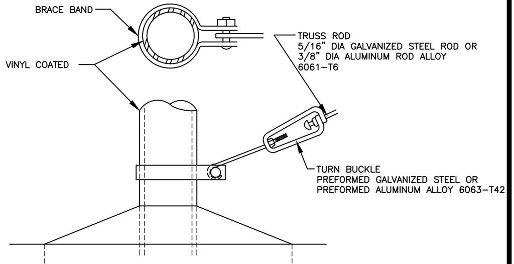
**TRUSS BRACE ATTACHMENT FOR ROUND CONSTRUCTION**
