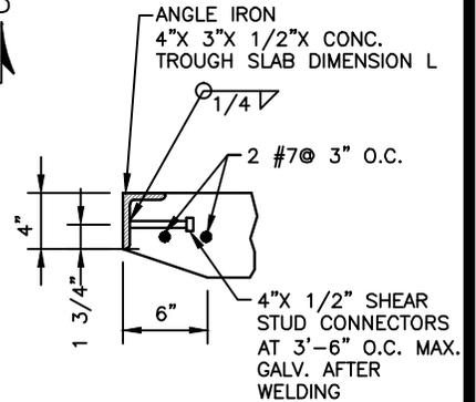
**PRECAST CONCRETE TOP SLAB**
