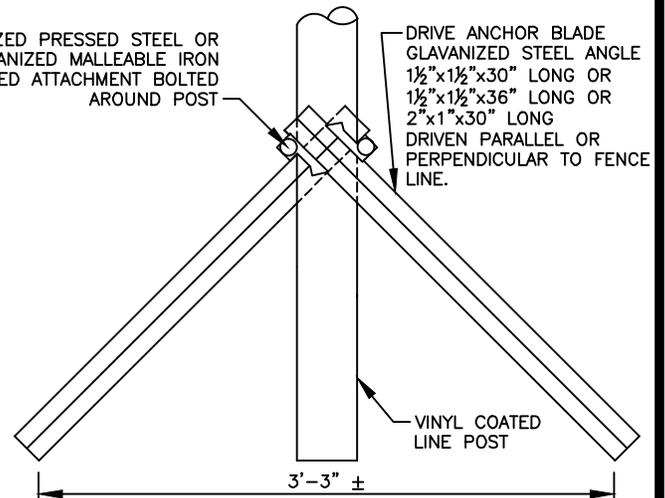
DRIVE ANCHOR BLADE GLAVANIZED STEEL ANGLE 1 1/2"x1 1/2"x30" LONG OR 1 1/2"x1 1/2"x36" LONG OR 2"x1"x30" LONG DRIVEN PARALLEL OR PERPENDICULAR TO FENCE LINE.
